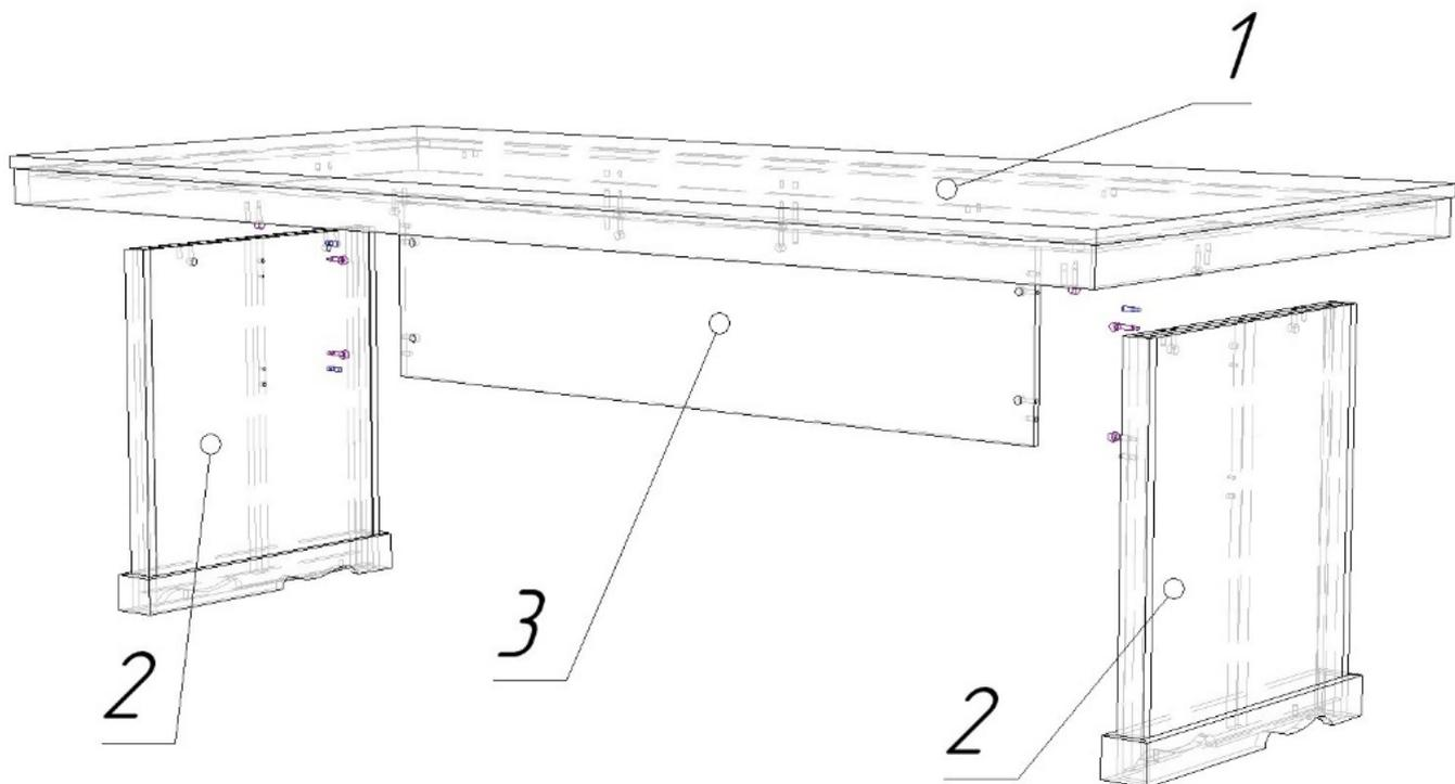
Вставить стяжки-эксцентрики (1) в отверстия 15x13 на плоскостях деталей. Забить шканты (3) в торцевые отверстия 8x20. Ввернуть дюбеля (2) стяжек-эксцентриков в отверстия 5x12 на плоскостях деталей. Соединить стойки 2 с панелью жесткости 3, затянуть отверткой, поворачивая по часовой стрелке, стяжки-эксцентрики (1). На полученном каркасе закрепить крышку 1.
