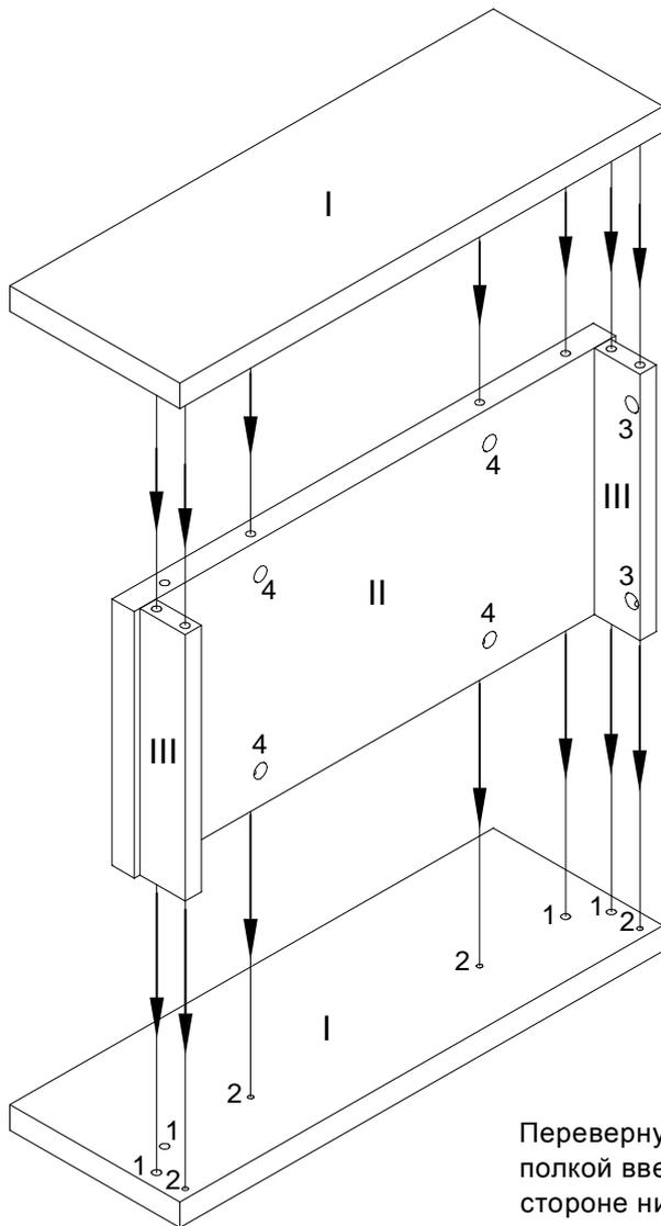
Положить боковины, нижнюю полку и планки отверстиями вверх. Забить в боковины шканты (1) и вкрутить дюбеля стяжек-эксцентров (2). Вставить в нижнюю полку стяжки-эксцентрики (4), а в планки стяжки-эксцентрики (3) стрелкой в направлении отверстий на торцах.
