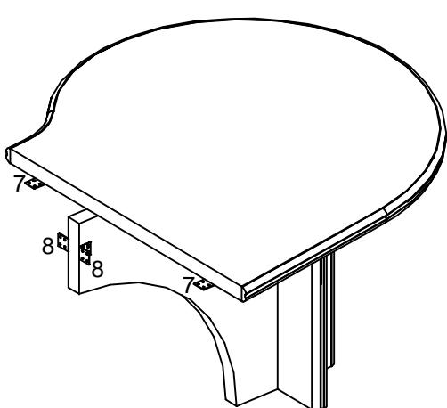
К средней панели прикрутить крепёжные уголки (8) с помощью винтов (9). Установить и прикрутить приставку к столешнице и боковине стола.
