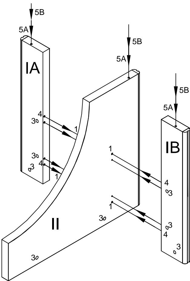
В боковины (I) забить шканты (4), вставить стяжки-эксцентрики (3). В среднюю панель (II) вкрутить дюбеля для стяжек-эксцентриков (1), вставить стяжки-эксцентрики (3). В боковины и среднюю панель забить крепёж опоры (5А) и ввернуть опоры (5В).
