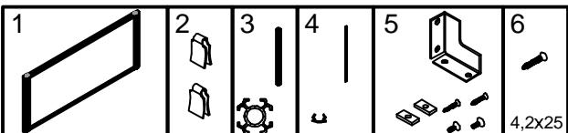
Экран (1) со скобами пружинными (2) и уголками крепления к столу (5) в комплекте. Стойка вертикальная (3) с саморезом резьбонарезным (6) в комплекте. Заглушка профильная (4). Количество элементов определяется дизайн-проектом.
