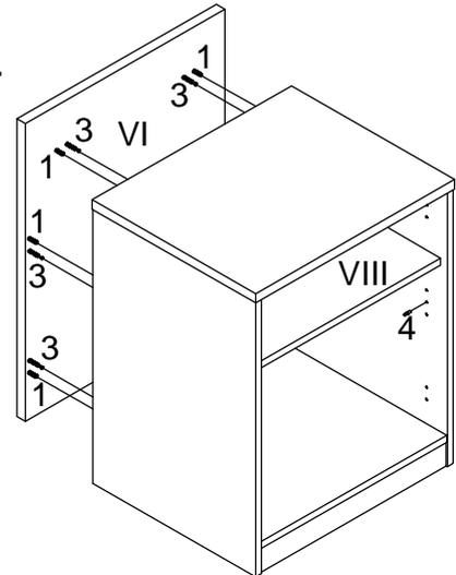
Установить в отверстия на поверхности стенок боковых (II,III) полкодержатели (4) и установить на них полку переставную (VIII) (см. рис. 3). Закрывать торцы стяжек-эксцентриков декоративными заглушками (8).
