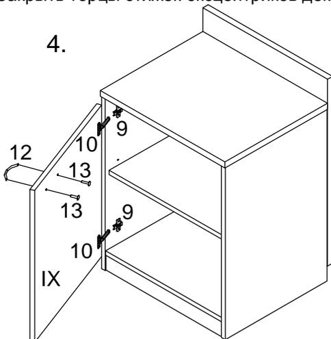
К стенкам боковым прикрутить ответные планки петель (9) имеющимися при них винтами. Досверлить насквозь пару глухих отверстий на тыльной стороне каждой двери сверлом Ø5мм, обязательно подкладывая при этом фальш-панель или брусок. К дверям шурупами (5) прикрепить петли (10), привинтить ручки-скобы (12) при помощи винтов (13) (см. рис. 4). Наклеить на планку (VII) самоклеющиеся амортизаторы (11) (см. рис. 2).
